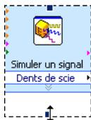
Comme l'entrée **Amplitude** apparaît dans le diagramme, vous pouvez configurer l'amplitude du signal en dents de scie à partir du diagramme.
